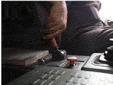
*Azione sul freno di stazionamento (meccanico e pneumatico)*
